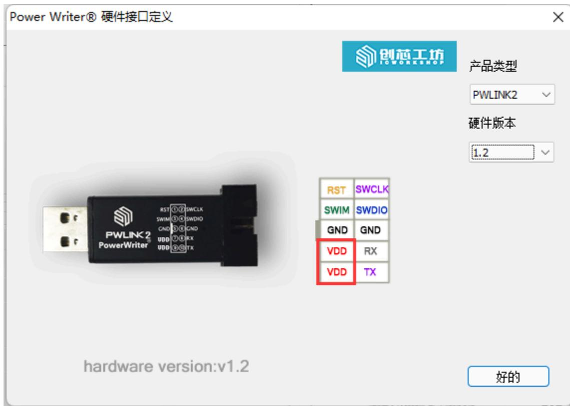
**VREF 5V:** 当PWLINK2、PWLINK2 Lite的引脚7和引脚9为VREF和5V时，此时5V引脚只输出5V 供电电压，不受控制；Vref引脚的工作模式可由上位机配置，默认状态下输出3.3V，可由上位机配置为5V 输出模式，或为内部提供通信参考电平的“输入模式”。其中sw引脚的通讯电平与Vref一致。丝印实例如下：
