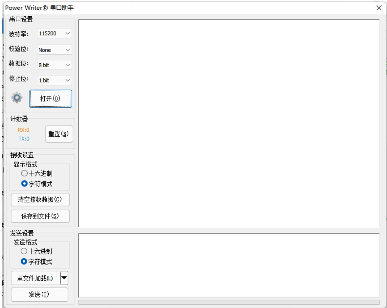
打开串口助手当做普通串口工具使用，接线图参考：
