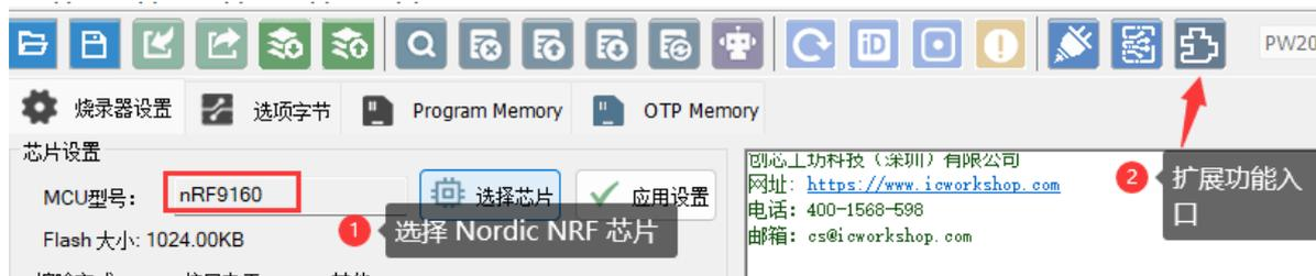
在选择完 Nordic 系列的芯片之后，在工具栏右侧出现一个扩展功能按钮，定义为**厂商特定插件功能**，通过点击此按钮进入到NRF 协议栈烧录的配置页面，如图所示：
