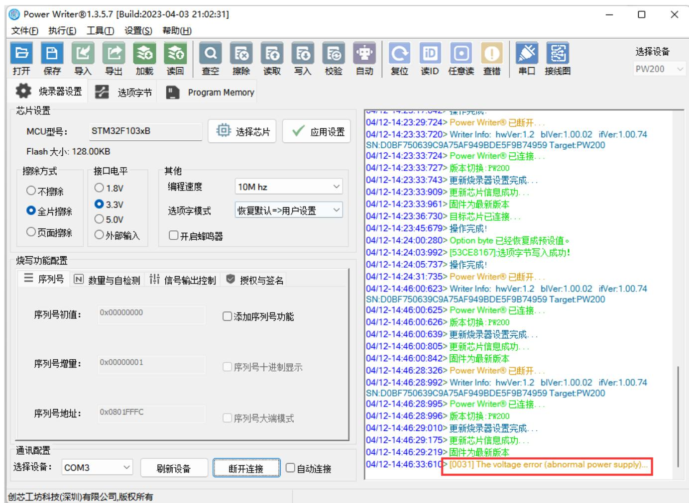
出现该提示时，请检查开发板的电路，存在短路状况，断开设备，调整之后重新连接。
