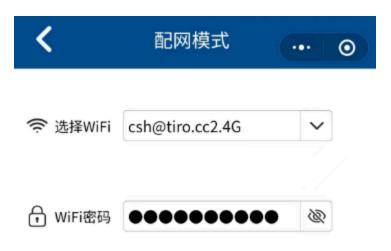
获取列表: iOS将跳转到系统设置中的微信设置页,需用户手动进入「无线局域网」设置页,并在系统扫描到设备后,小程序才能收到并同步。Android 不会跳转,但是需要打开位置权限
