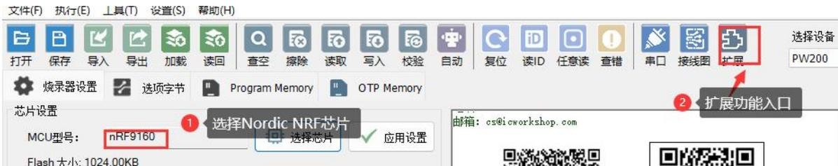
在选择完 Nordic 系列的芯片之后，在工具栏右侧出现一个 扩展功能按钮，定义为 厂商特定插件功能，通过点击此按钮进入到NRF 协议栈烧录的配置页面，如图所示：
