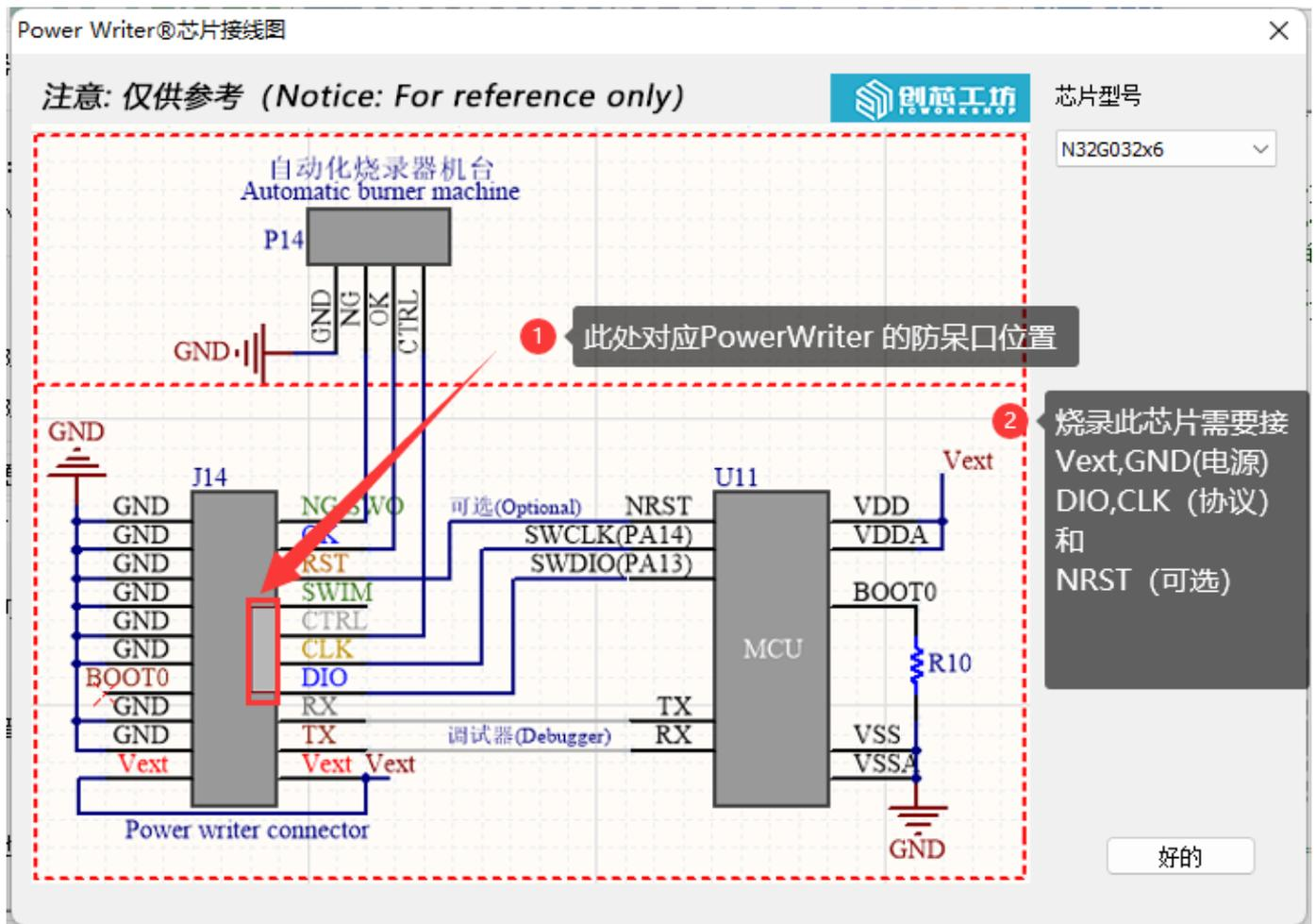
PowerWriter 的接口信号如上图的Socket 脚位，也可以通过 菜单 -> 工具 -> 查看PowerWriter 接口定义按钮查看
